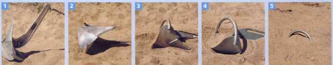
Wenn ein Bügelanker (hier der Manson Supreme) auf dem Kopf oder dem Rücken auf dem Ankergrund landet (1), rollt er unter Zug über den halbkreisförmigen Bügel auf die Seite (2+3). In weichem Grund dreht sich das Eisen bedingt durch die Form der Flunke direkt mit der Spitze in den Grund, der Bügel weist nach oben (4). Nach einem knappen Meter ist der Anker tief eingegraben (5)
