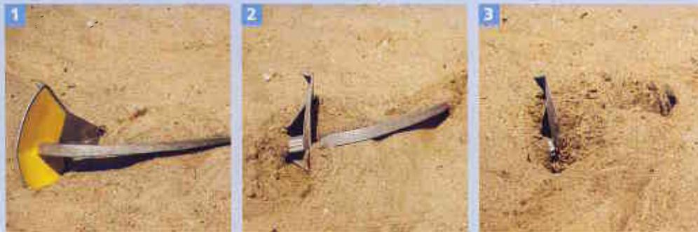
Liegt der Anker seitlich auf dem Grund und gerät unter Zug, dreht sich die schwere, mit Blei ausgegossene Spitze nach unten (1+2). Dabei rutscht der Anker nicht lange über den Boden, sondern sticht wie ein Spaten fast senkrecht in den weichen Sand
