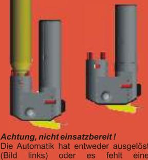
**Achtung, nicht einsatzbereit!** Die Automatik hat entweder ausgelöst (Bild links) oder es fehlt eine Komponente (Bild rechts: die Pressgaspatrone).
