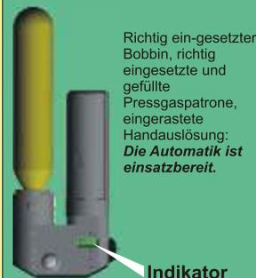
Richtig eingesetzter Bobbin, richtig eingesetzte und gefüllte Pressgaspatrone, eingerastete Handauslösung: Die Automatik ist einsatzbereit.
