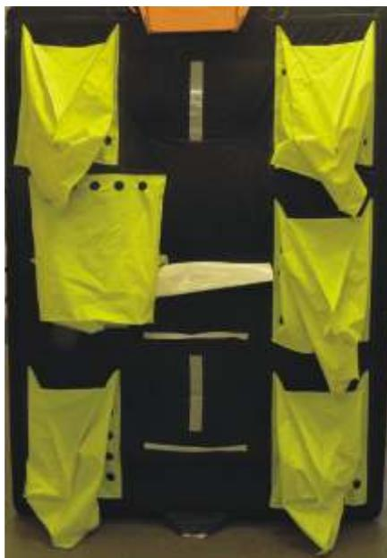
Abb.: Kenterschutzsäcke unter der Rettungsinsel RFY 6
