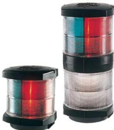
Kombinationslaternen für sparsamen Stromverbrauch. Raumsparende Anbringung auf dem Mast. Seewasserfest und amagnetisch. Bajonettverschluß des Lichtgehäuses ermöglicht leichten Glühlampenwechsel. Eingebaute Longlife-Glühlampe 12V. Sonderausführung mit kombiniertem Ankerlicht.
