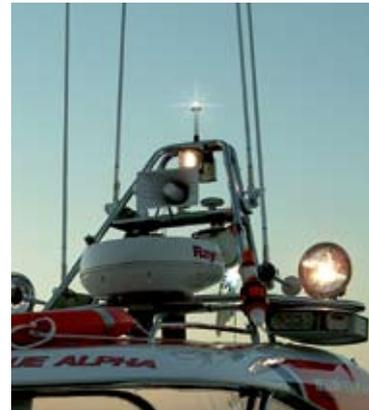
Die Laternen der NaviLED®360 Modellreihe verwenden fortschrittliche Multivolt™ Schaltkreise, um eine gleichmäßige Lichtleistung und somit Sicherheit zwischen 9 und 33 Volt DC sicherzustellen - selbst bei starken Spannungsschwankungen oder niedriger Batteriespannung.
