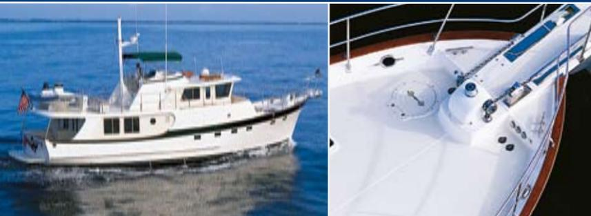
Die HWC Serie ist für die automatische horizontale Bedienung von Ankergestängen nur mit Kette konzipiert und bietet eine unabhängige Spill zur Rückholung eines zweiten Seil- und Ketten-Gestänges oder Unterstützung bei Andockmanövern.
