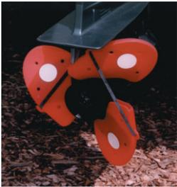
Die patentierten Prop Sox werden über die Schraubenflügel gezogen und bilden damit den
