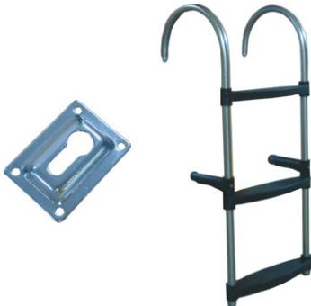
Badeleiter aus 25mm Edelstahlrohr. Die 35cm breiten Stufen bestehen aus schwarzem Polypropylene. Die Abstandhalter und die Griffbügel sind zur Seite drehbar um ein einfaches Verstauen zu ermöglichen. Spezielle Grundplatten sichern die Leiter und sind als Zubehör erhältlich.
