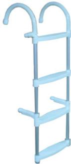
Badeleiter aus 25mm seewasserfestem Aluminiumrohr. Die 35cm breiten Stufen bestehen aus Polypropylene. Die Abstandhalter und die Griffbügel sind zur Seite drehbar um ein einfaches Verstauen zu ermöglichen.
