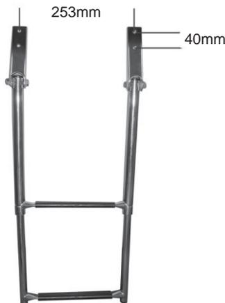
Teleskop-Badeleiter aus 25mm Edelstahlrohr. Die 23cm breiten Stufen bestehen aus Edelstahl und sind mit schwarzem Kunststoff verkleidet. Die Badeleiter wird fest montiert und kann bei Nichtgebrauch hochgeklappt werden. Dadurch versinken die unteren Stufen und nehmen nur eine geringe Höhe in Anspruch.
